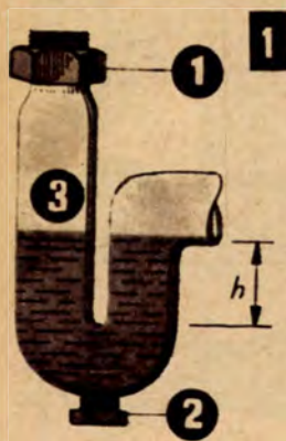
Az S-szifon részei: 1. Felerősítő anyó, 2. Tisztító csavar, 3. Szifontest
