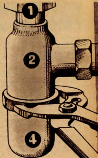
A búraszifon szétszerelése: 1. Csatlakozó anya, 2. Ház, 3. Lefolyócső, 4. Szennygyűjtő tartály, 5. Csővég
